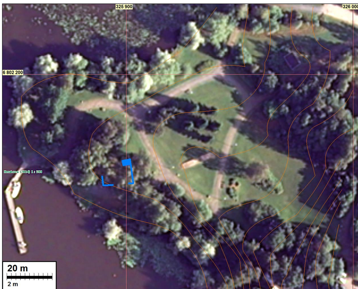
Ilmakuva alueesta, johon on päälle tulostettu 1 m korkeuskäyrät. Betonirakenne sinisellä.
